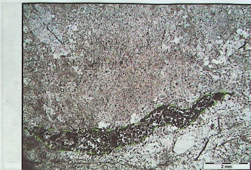
Figura 24: Aglomerado de espinélio e silimanita deformado em matriz leucocrática. Seção ARA-V-01D. Fotomicrografia sem analisador, lente: 1.25x.
